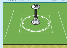
⑧押えキャップ・ナット・天板を取り付ける
