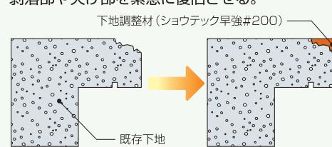
既存アスファルト防水撤去下地の部分的な水溜り補修をする。
