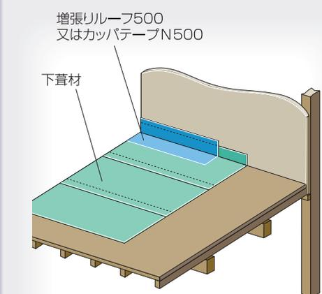
下葺材施工後に「増張りルーフ500」又は「カッパテープN500」をタッカーで張り付ける。
