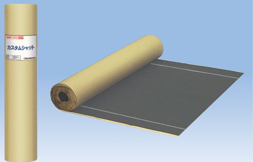
改質アスファルトを使用し、さらに合成繊維不織布と合成繊維メッシュのダブル採用により、引裂強度を強化した高級粘着層付改質アスファルトルーフィングです。釘穴シール性・耐久性に優れ、また接着力・破断抵抗性が大きいので、低温時の施工にも優れています。
