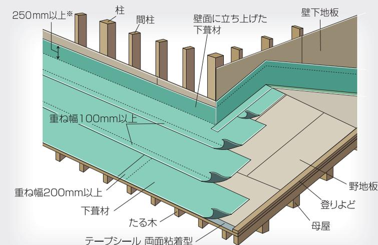
※下葺材は、250mm以上かつ雨押え上端の50mm以上壁面に立ち上げる。
