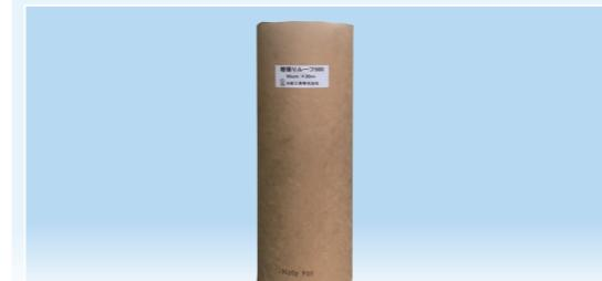
耐久性・低温可撓性に優れた改質アスファルトと2層の合成繊維不織布をラミネートし、表面を鉛物質粉粒及び合成樹脂塗料で仕上げた屋根増張り専用のルーフィングです。
