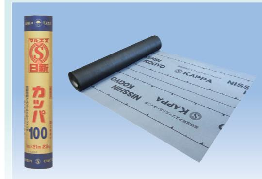
高品質の厚手合成繊維不織布に、改質アスファルトを浸透・被覆し、裏面に薄手合成繊維不織布を張り合わせた高耐久の製品です。引張性能・伸び・引裂性能に優れています。更に、柔軟性が高いことで施工性にも優れています。
